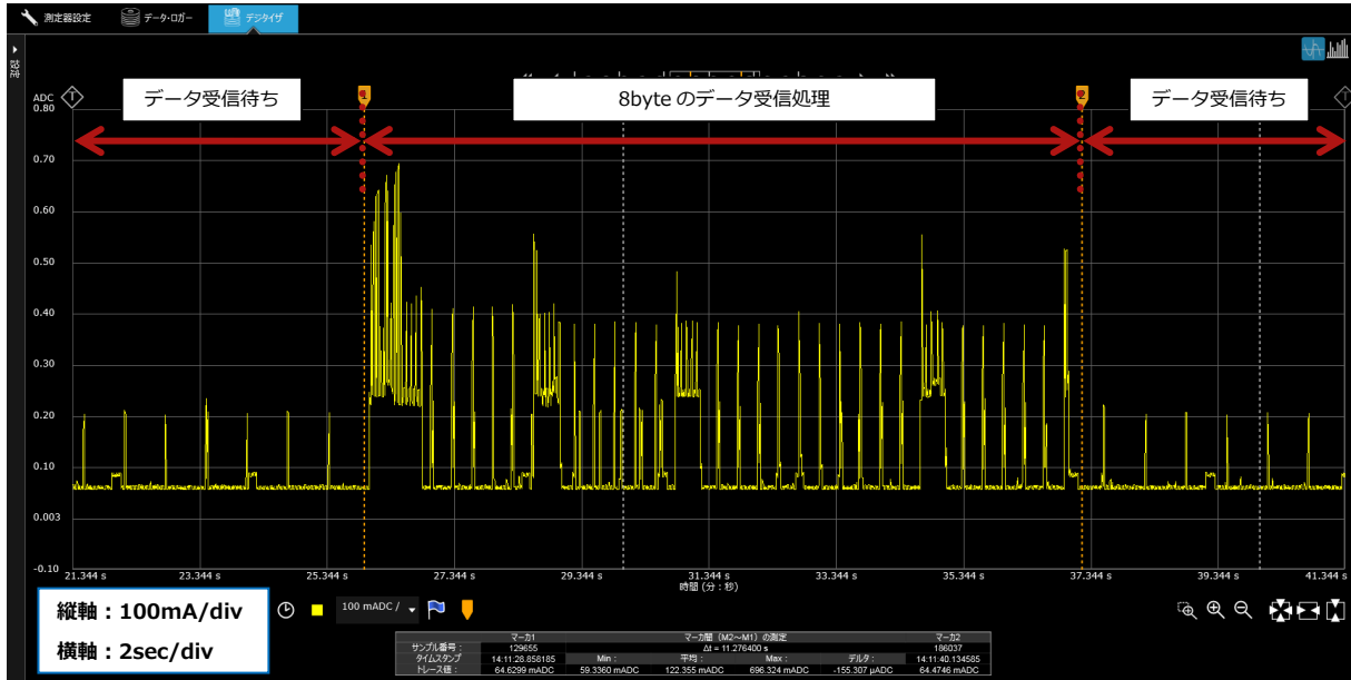
Figure 14 データ待ち受け時に 8byte 受信 (省電力制御無効)
