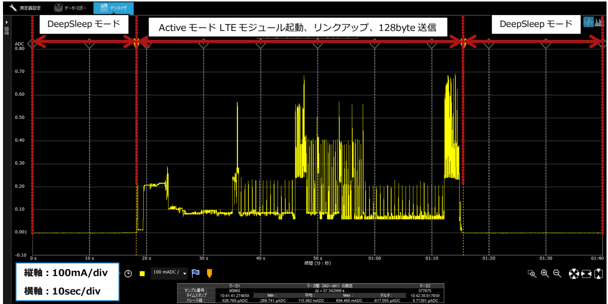
Figure 6 DeepSleep の合間に 128byte 送信 (省電力制御無効)
